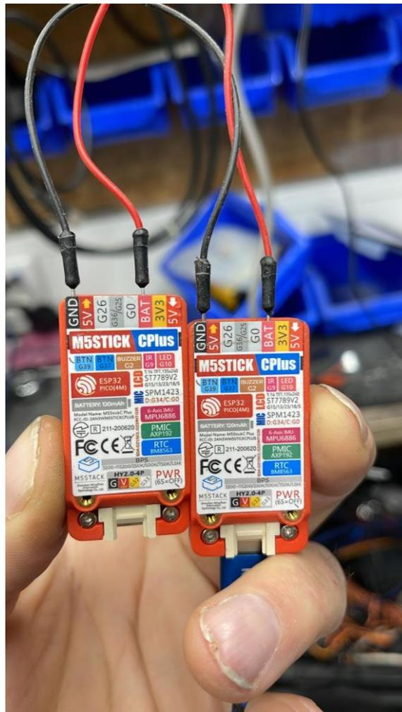
Ein Lipo Ladegerät nehmen, Ladeprogramm 1S einstellen, 100 mA Ladestrom einstellen und + auf Batt und – auf GND stecken. 10 Minuten laden lassen und dann das Ladeprogramm beenden. Danach kann wieder über die USB Schnittstelle geladen werden. Auf keinen Fall direkt mit 5 Volt auf diesen Eingang gehen sondern nur mit einem Lipo Lader.
