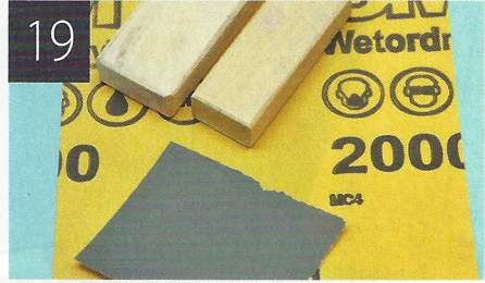
Schleifpapier der Körnung 2.000 und zwei für diesen Schleifzweck speziell zurechtgemachte Schleifklötzchen aus Abachi.
