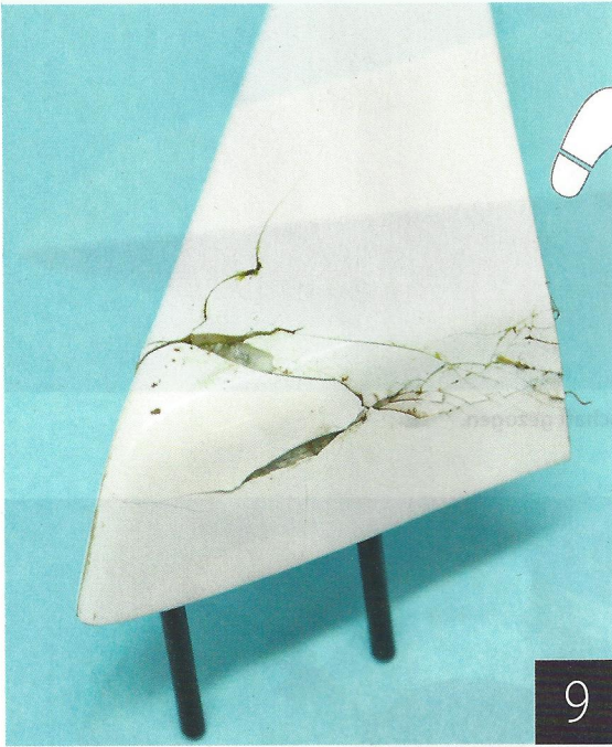
Wüste Sache: Das provisorisch zurechtgedrückte und mit Sekundenkleber fixierte Winglet...
