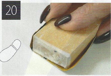
Mit ausreichend Wasser schleift man immer mit dem Klotz.
