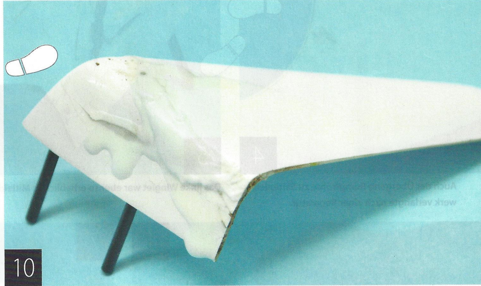
... sieht mit eingedicktem Epoxidharz verspachtelt immer noch nicht wirklich schick aus, ...
