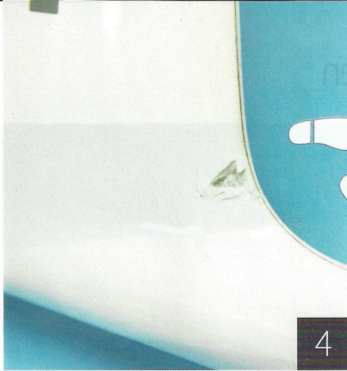
Auch der Übergang Rumpfröhre zu Seitenleitwerk verlangte nach einer Reparatur.
