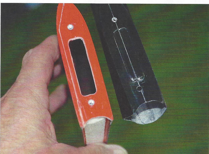
Die auf den Rumpf zu schraubende Seitenflosse mit den nötigen (perfekten) Passungen
