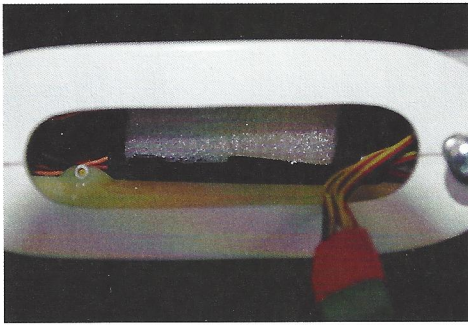
Der Empfänger sitzt unter der Fläche im Rumpf, mit zwei Schaumstoffteilen verkeilt
