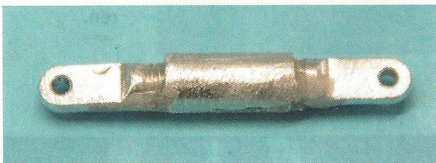
Mein selbst gebautes Ruderhorn zur doppelseitigen Anlenkung des Seitenruders...
