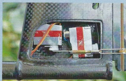
Beide Servos vor Ort eingeklebt, Blei darunter in der Röhre verharzt
