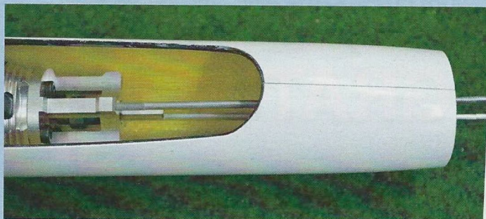
So! Zwei M3-Gewindestangen, durch zwei der Befestigungslöcher im Motorspant nach hinten geschoben und ins Frästeil eingedreht, gestatten das passgenaue Nach-vorne-Ziehen der Antriebseinheit
