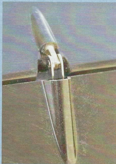
Eingedrehte und mit Sekunde gesicherte Ruderanlenkung
