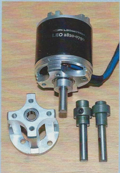
Leomotion-BL-Außenläufer mit zwei Fernwellen und Zurückversetz-Frästeil
