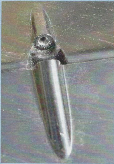
Fertig eingeschnittenes Gewinde auf der Ruderseite
