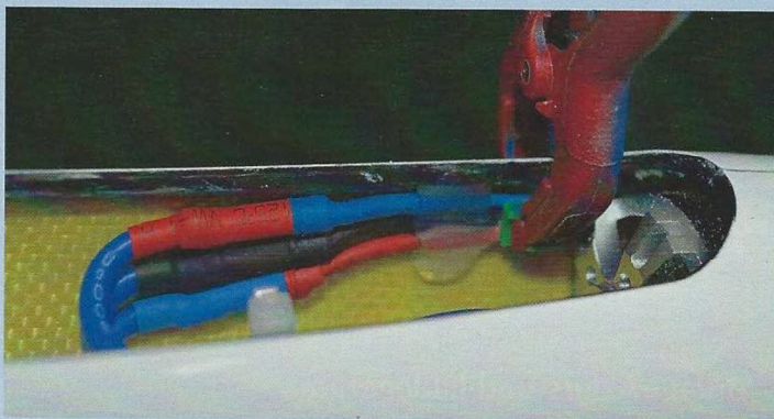
Die Motorkabel sind mit Silikon an der Rumpfwand festgemacht, was ein Durchscheuern an der Glocke verhindert
