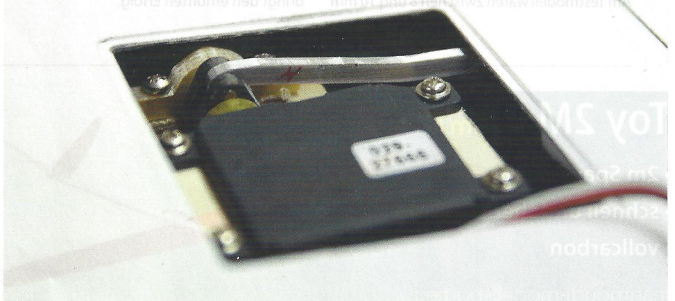
Beim Querruderservo steht der Abtrieb auf null.
