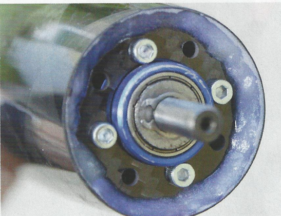
Das ist der stecklandungsfest mit Mumppe verharzte CFK-Motorspant.
