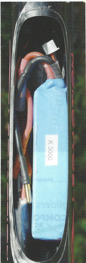
Eng, enger, Neutrino. Bei einem größeren Akku (hier: 3s-1.800-mAh-LiPo) wird's klaustrophobisch.
