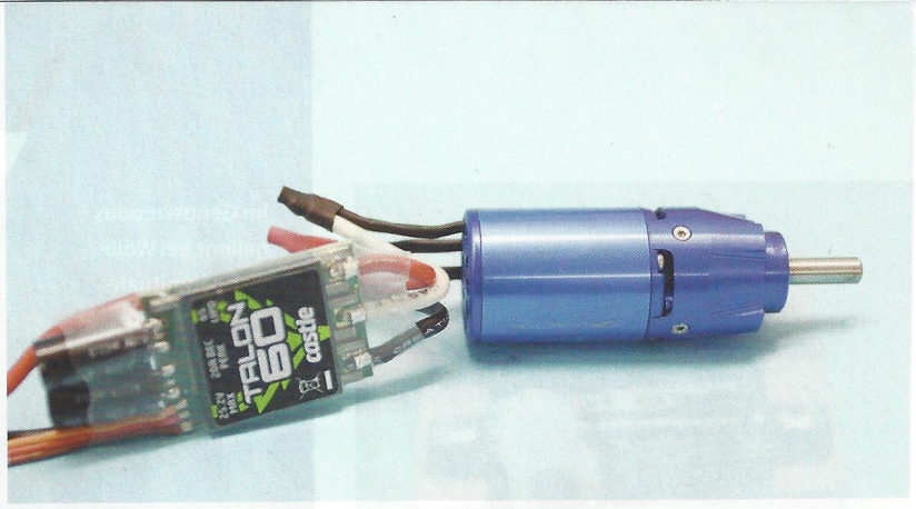
Diese Spezialverlötung von Motor und Regler schafft vernünftige Einbauverhältnisse.
