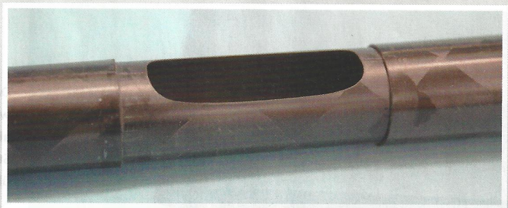
Funktion trifft Exklusivität: Das ist der Servoschacht in der hinteren Rumpfröhre, rechts das kaum aufgeschobene Vorderteil.
