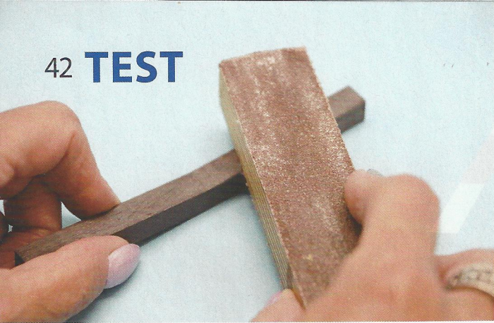
An allen Flächenverbindern war Feinschliff nötig, damit sie mit dem verlangten „Plopp“ passen.
