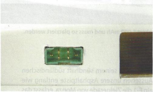
... damit die MPX-Stecker bündig zur Anschlussrippe eingeklebt werden können.
