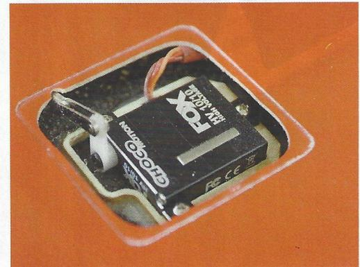
Die kleine Halbrundaussnehmung oben links sorgt für den nötigen Gestänge-Freiheitsgrad im Klappenschacht.
