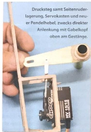
Drucksteg samt Seitenrudern-lagerung, Servokasten und neuer Pendelhebel, zwecks direkter Anlenkung mit Gabelkopf oben am Gestänge.
