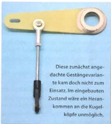
Diese zunächst ange-dachte Gestängevariante kam doch nicht zum Einsatz. Im eingebauten Zustand wäre ein Herankommen an die Kugelhöcker unmöglich.
