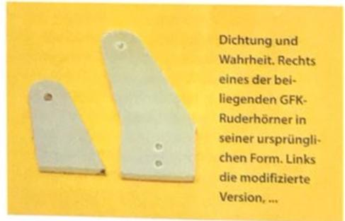
Dichtung und Wahrheit. Rechts eines der beiliegenden GFK-Ruderhörner in seiner ursprünglichen Form. Links die modifizierte Version, ...
