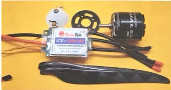
Diese treibenden Kräfte funktionieren phänomenal: Dualsky XM 5060 EA-14 V3, hier noch mit ICE-Regler, der gegen einen Flyfun 120 BEC getauscht wurde. Dazu kommt ein Leomotion-18x13-Zoll-Propeller.
