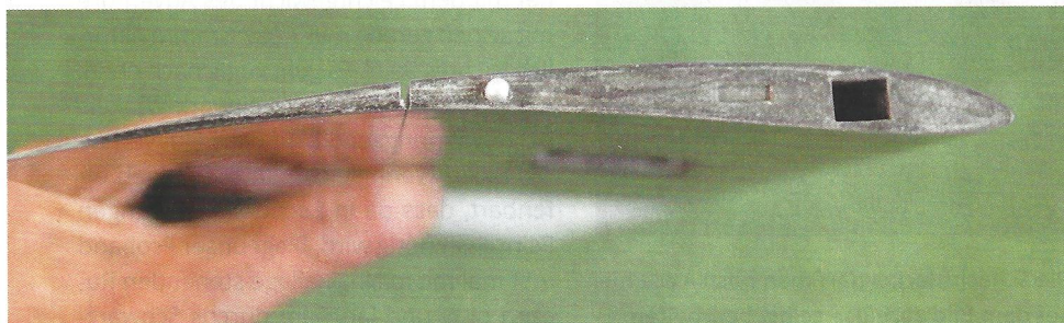
Sieht fast nach Freiflug aus: Das Profil mit nur 7% Dicke.
