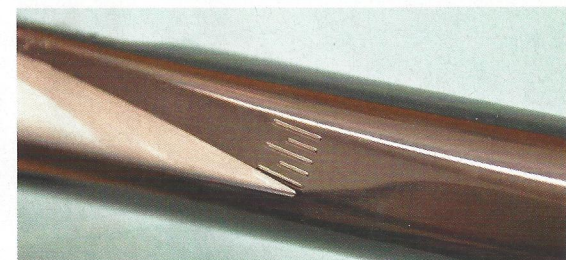
Diese Markierung am Rumpf ermöglicht das exakte Ausrichten (Neutrallage) der Flächenklappen.
