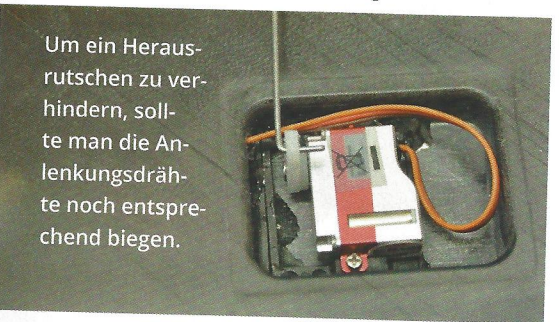
Probesitz des Wölbklappen-Servos. In diesem Zustand ist weder das Ruderhorn noch der Servorahmen verklebt. Grund: Einstellung der Neutrallage.
