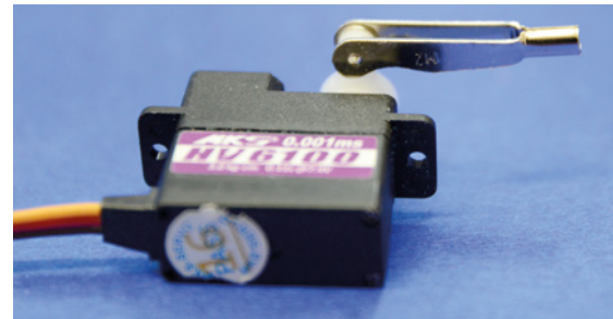
Um auf Höhe/Seite die nötigen Ausschläge liefern zu können, ohne am Servoantrieb anzuecken, sind die Gabelköpfe wie auf dem Bild gezeigt zu bearbeiten.
