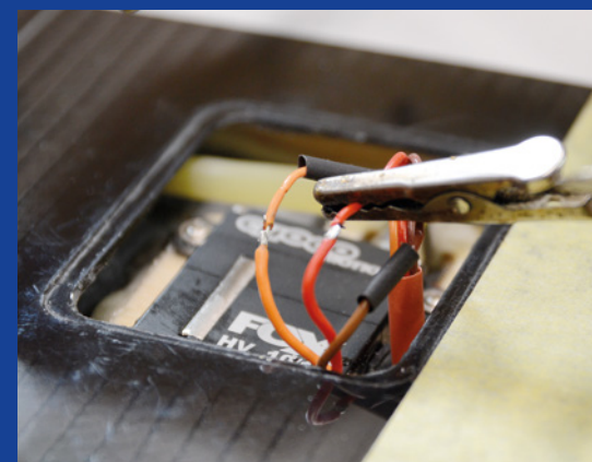
Die herstellerseitig in den Flächen verlegten Kabel verlangen ein sorgfältiges Verlöten und Verschrumpfen.
