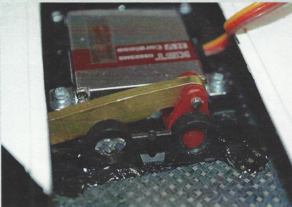
Komplett eingebaute LDS-Anlenkung, hier an den inneren Wölbklappen
