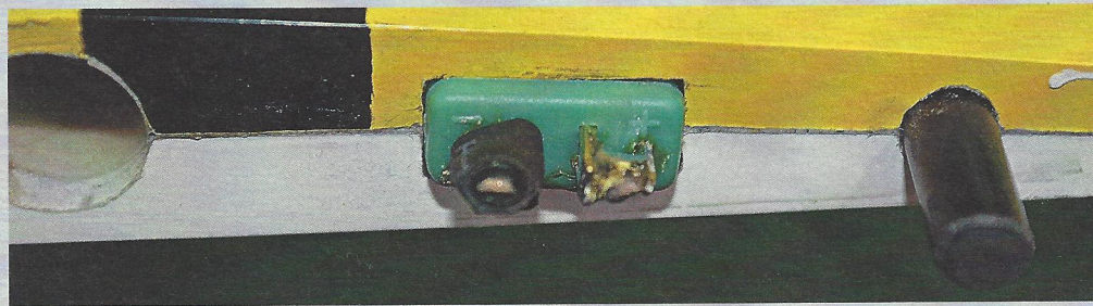
Oben: Einkleben des Servosteckers in der Fläche. Eine eingewachste (alte, nur hier für missbrauchte) Buchse verhindert das ungewollte Eindringen von Kleber
