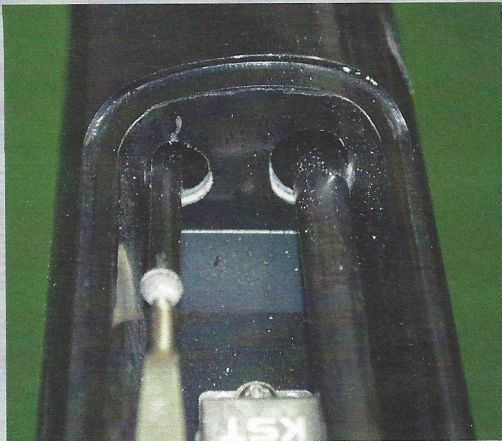
So laufen die CfK-Schubstangen in den kreisrunden Rumpfdurchbrüchen
