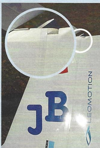
Auch das ist Serie: Die Dichtlippen am Seitenleitwerk sind werkseitig angebracht
