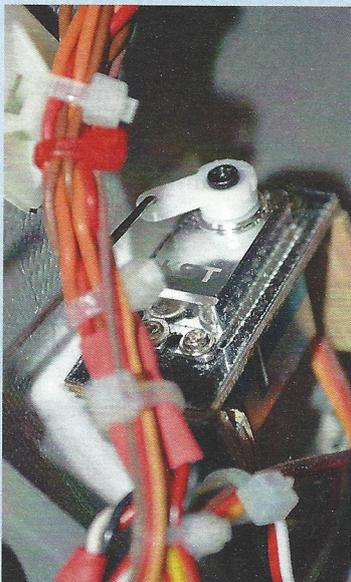
Links: versteckt sich dezent hinter meinen seitenrichtig zusammengefassten Kabelbäumen: das Schleppkupplungs-Servo. Die Halterung ist Eigenbau, der Servo-Kraftzweig, ein KST-HV-DS 31 MG, stemmt immerhin vier Kilogramm
