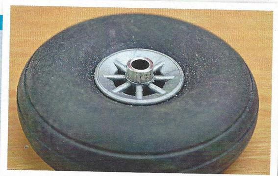
Perfektion am Rad selbst: Die Radachse des Heckrades ist passgenau ausgebocht
