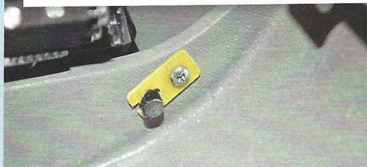
Über solche GfK-Laschen erfolgt die Sicherung der genutzten Stangen am Spant
