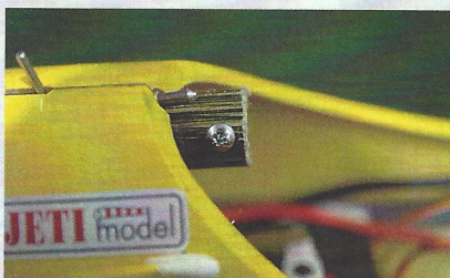
Das Behältnis kommt nur so weit in den Rumpf hinein, dass die Schraube noch gut zu handhaben ist und die Kabinenhaube berührungslos bleibt
