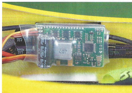
Der Regler sitzt an der rechten Rumpfsseitenwand, ...
