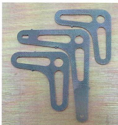
Aus diesen drei CfK-Teilen entsteht der Pendelhebel
