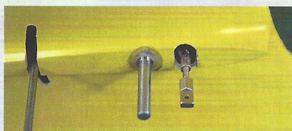
Die linke Leitwerkshälfte sitzt samt Schnapp am Rumpf, eingedicktes Harz ins Loch der anderen Hälfte eingeben und alles zusammenstecken
