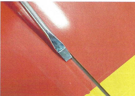
Mit einem passenden Schraubendreher (Klingenbreite) gut andrücken
