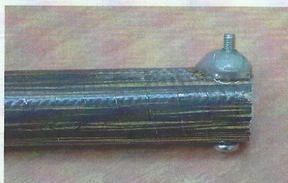
Damit es besser hält, harzt der Autor Einschlagmuttern verkehrt herum an
