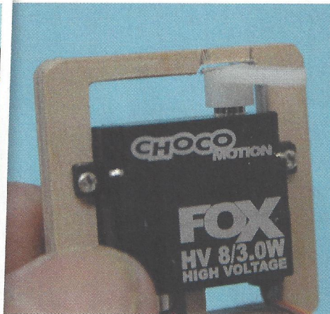
Modifizierter Servorahmen im Bereich des Abtriebshebels
