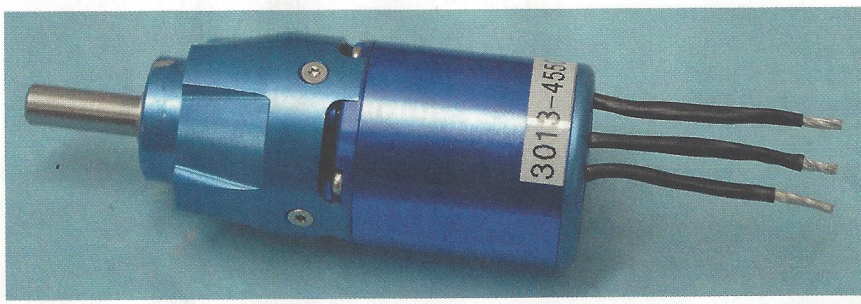
Liegt außerhalb der Wettbewerbsnorm, bringt aber fulminante Steigflugpower: Leomotion 3013-4550. Ein richtiger F5J-Antrieb ist deutlich kleiner und leichter
