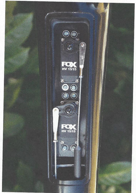
Die Servos im Rumpf verbergen sich später unter einem passgenauen Deckel
