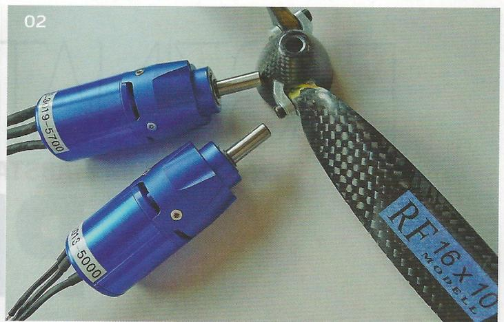
**01** | Ein alltagsoptimierter F5J-Antrieb „L3013“: 99 Gramm mit Mikrogetriebe, beziehungsweise 135 Gramm mit Normalgetriebe **02** | Namhafte Hersteller wie Leomotion (Bild) und Florian Schambeck bieten leistungsfähige Motoren an
