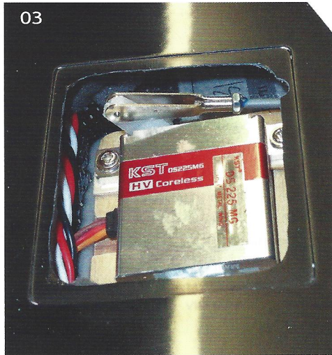
01 | Die Antriebs- und Ausstattungskomponenten auf einen Blick 02 | Maximal 5S-LiPo passen in den „Attacko“-Rumpf 03 | Die KST-Servos, hier an den Wölbklappen, haben sich als robust und stengenau bewährt 04 | Motor, Regler und Propeller bilden eine Top-Kombination für den Hotliner
