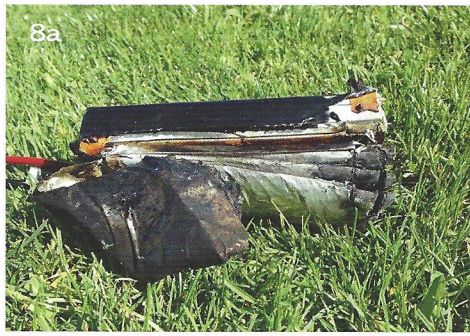
8a+8b | In diesem LiPo-Akku hat ein Propeller eingeschlagen 09 | Sichere Aufbewahrungsbehältnisse sind Pflicht beim Lagern in Innenräumen
