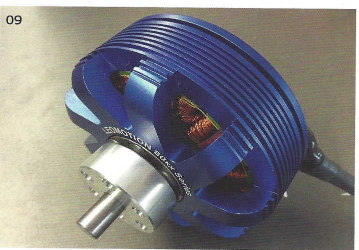
Bild 08 | Das Resultat von falschem Fett: zersetzte Nadellager der Planeten Bild 09 | Durch Erhöhung der Windungszahl und der magnetischen Pole lässt sich ein Elektromotor auch ohne zusätzliche Mechanik untersetzen
