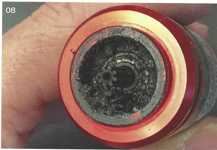
Bild 08 | Das Resultat von falschem Fett: zersetzte Nadellager der Planeten Bild 09 | Durch Erhöhung der Windungszahl und der magnetischen Pole lässt sich ein Elektromotor auch ohne zusätzliche Mechanik untersetzen
