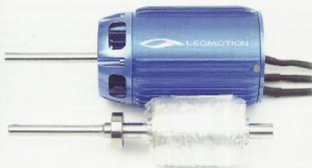
Hier der Magnet auf einer 8-mm-Welle, die vorne abgedreht ist, so ist exakter Rundlauf möglich. Dahinter das passende L50-Gehäuse
