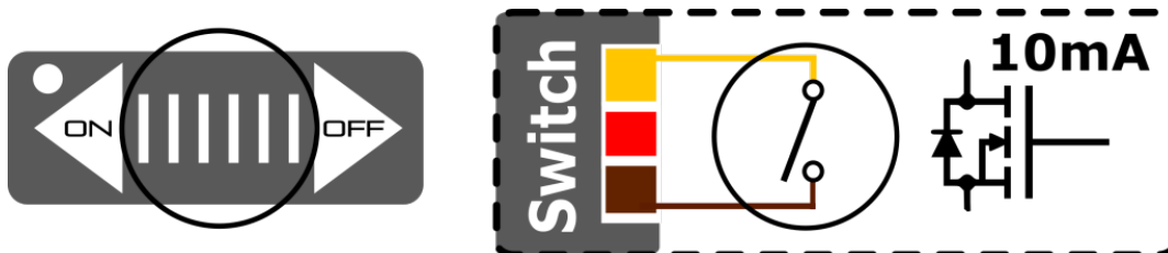
Vereinfachtes Schaltbild des Berührungsschalters
