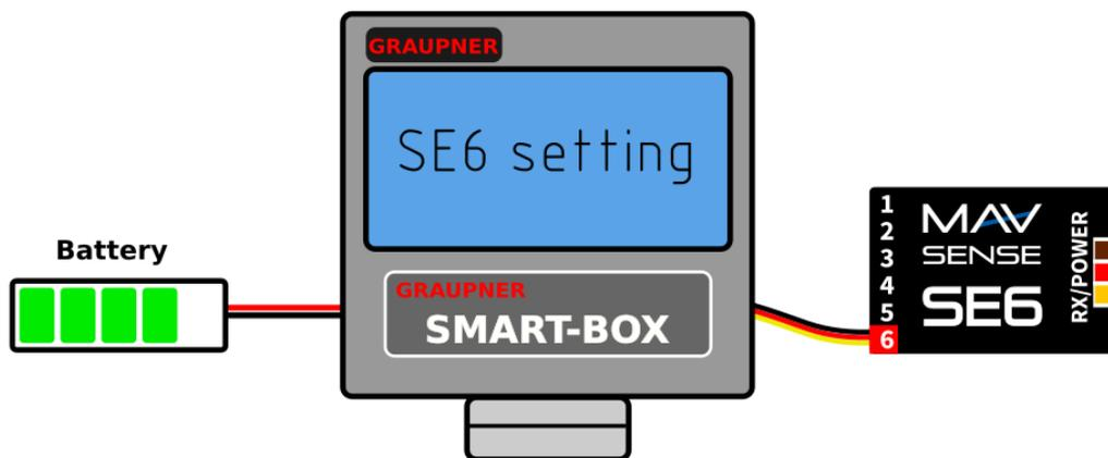
Optionale SMART-BOX-Anbindung. Der Ausgang Nr. 6 muss auf die Option „Ch6: Sensor EX“ konfiguriert werden und das SUND-Signal muss am MR30-Anschluss erkannt werden.
