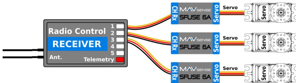
SFUSE verfügt über eine Stromversorgungsfilterung, die durch Kondensatoren ergänzt wird, die die zum Empfänger übertragene Spannungswelligkeit reduzieren und die Leistung des Empfängers beeinträchtigen.
