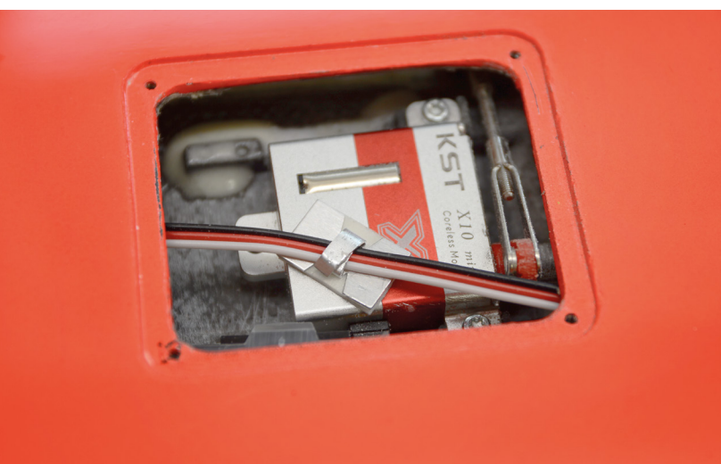
Bei den Wölbklappen hat der Hersteller den Über-Kreuz-Weg eingeschlagen. Das vom Autor gesicherte Kabel läuft weiter zum Querruderservo.
