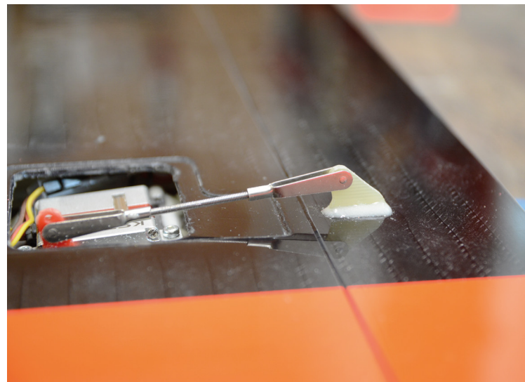
Nach alter Väter Sitte: die Querrudieranlenkung auf der Profilunterseite. Funktioniert im vorliegenden Fall spielfrei.
