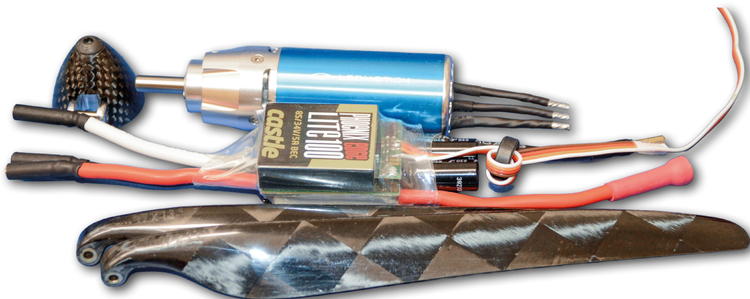
Sorgen für einen geradezu waffenscheinpflichtigen Steigflug: Leomotion L 3031-3250 mit 6,7:1-Getriebe, Phoenix Edge Lite 100 BEC und Leomotion-18×13"-Propeller.
