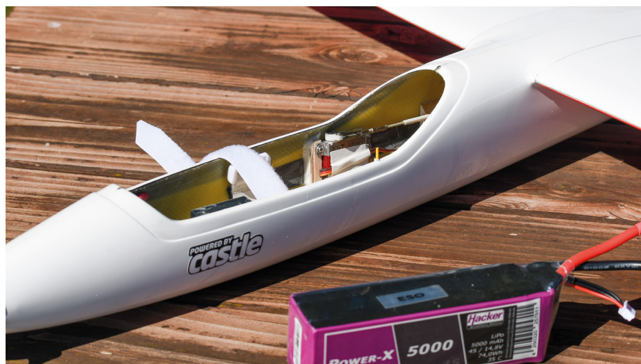
▲ Der Regler muss an die Seitenwand verbannt werden...
