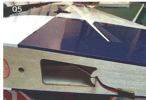
01 | Die Anordnung der Antriebskomponenten und der Rahmen für die Rumpfföffnung zur optimalen Belüftung 02-04 | Die Zwangsbelüftung mit einem abgewinkeltem Nylonrohr aus dem Sanitärbereich 05 | Das Modell bietet ab Werk viele interessante Details, wie zum Beispiel die Kabelhalterung in den Wurzelrippen
